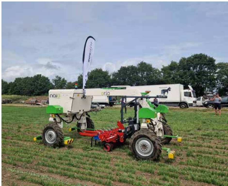
Maskin som utför precisionsrensning av ogräs i stråsåd kan minska behovet av energikrävande kemisk bekämpning. Bild: Sven Bernesson.
