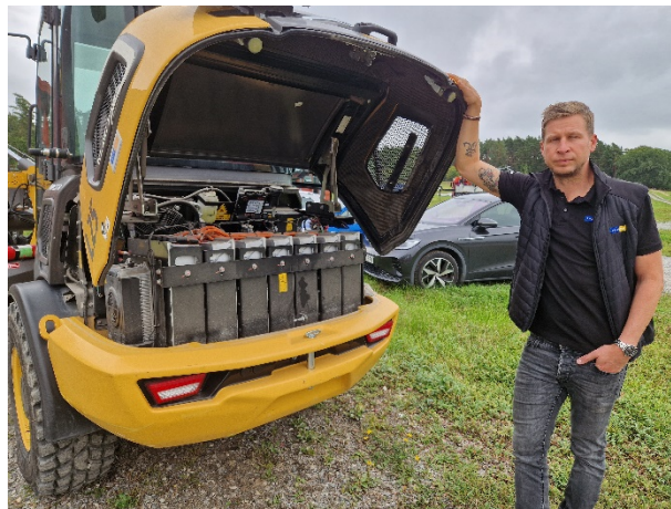
Dennis Andersson, från Swecon, visade bland annat upp en Volvo L25 Electric hjullastare där batterierna placerats längst bak för att fungera som en effektiv motvikt till lastaren i fronten.
